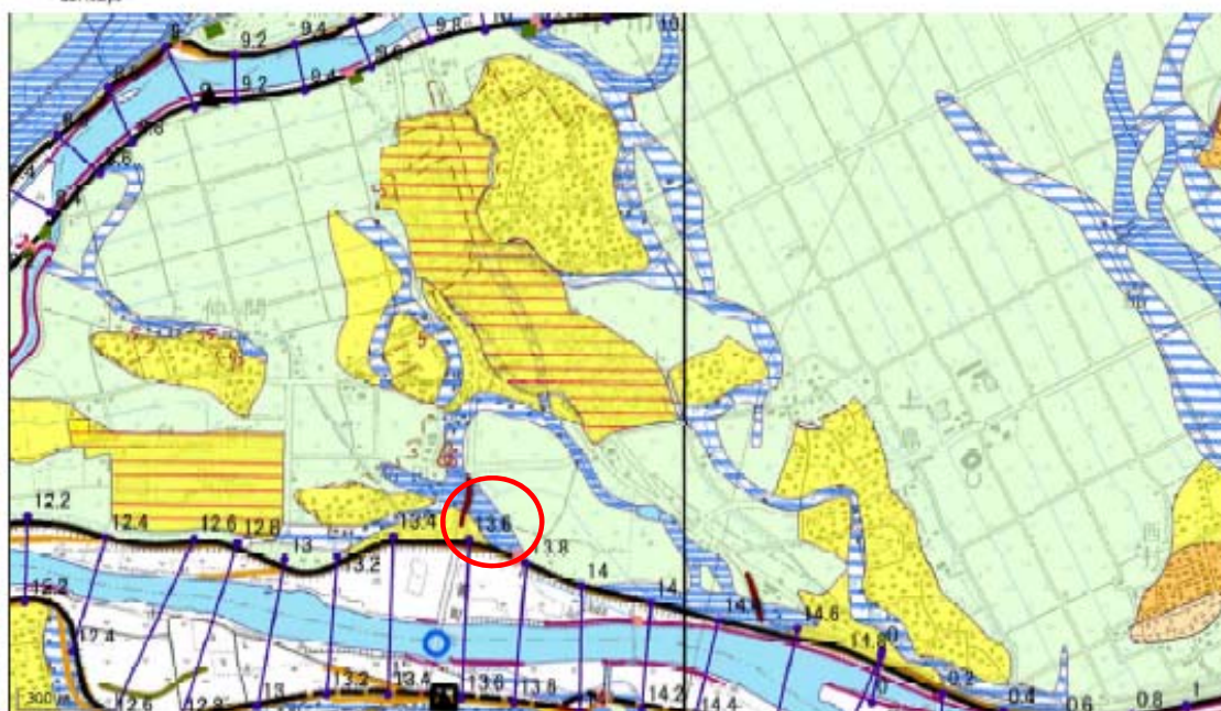
旧河道と考えられる地点における液状化
