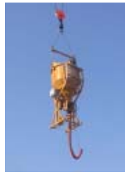
写真-11 コンクリート打設用ホッパー
