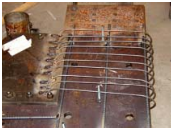
写真-3 Ω型割裂防止筋の溶接
