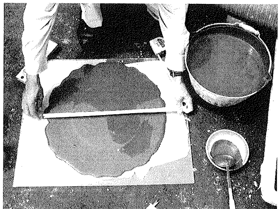
写真-6 シリンダー法によるフロー値の測定試験
