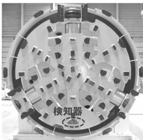
写真-3 磨耗検知装置を埋め込んだビットの磨耗量計測
