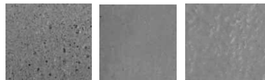
左：ベニヤ、中：パネコート、右：金ゴテ仕上げ 写真-2 試験体の表面
