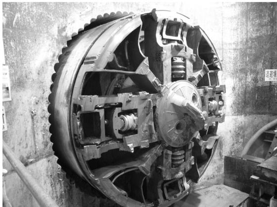
写真-2 面板の破損
