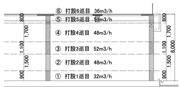
図-6 打込みリフト高さ図
