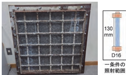
図-5 モックアップ試験体および照射範囲
