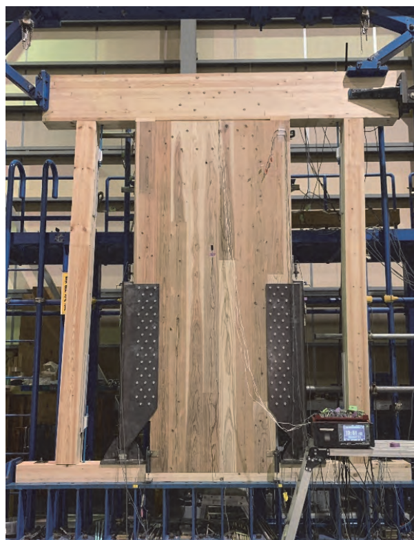
写真-1 制震システムの外観
