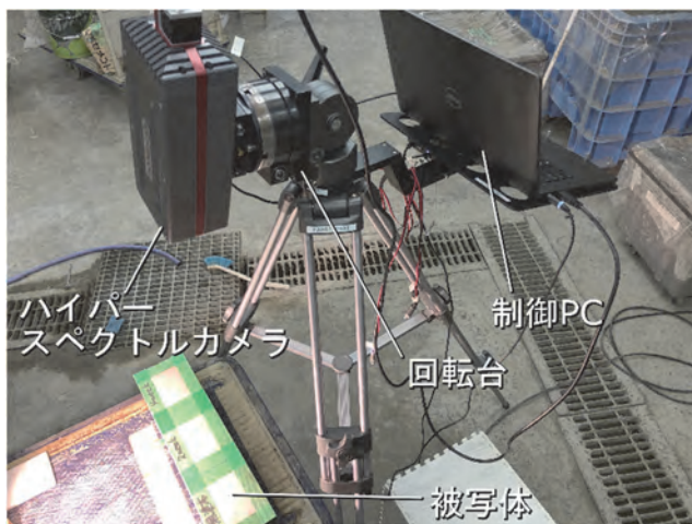
図-1 ハイパースペクトルカメラを用いた計測状況
