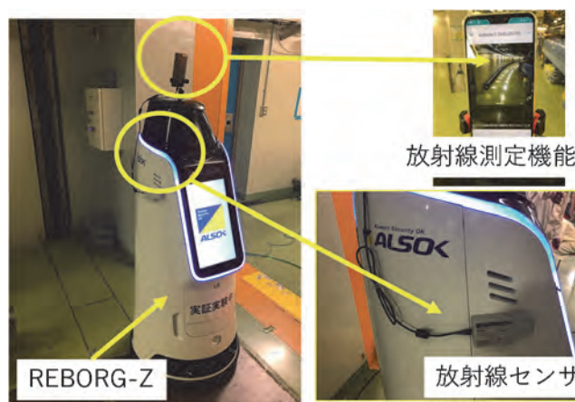
図-2 自律走行ロボットによる放射線測定状況の一例
