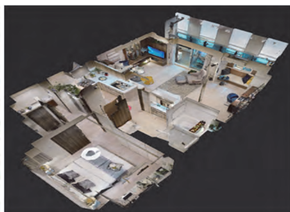
図-2 3Dスキャナーにより作成した3Dデータ
