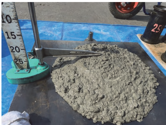
写真-1 圧送前のフレッシュコンクリートの品質検査
