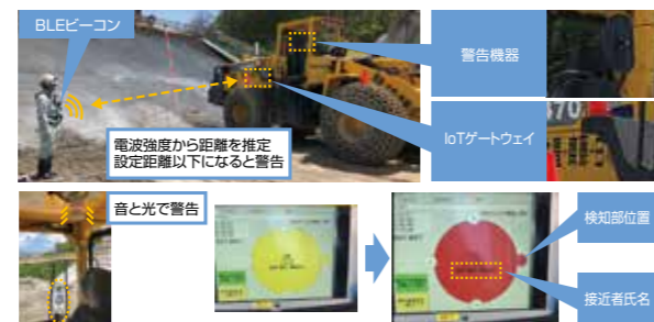
BLEビーコンの発信電波から周辺の人の接近と接近者名を表示・警告
