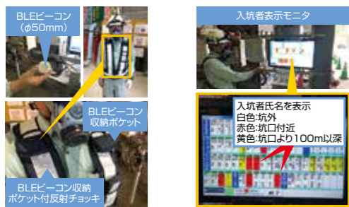
BLEビーコンの発信電波から入坑者名・位置をリアルタイム管理
