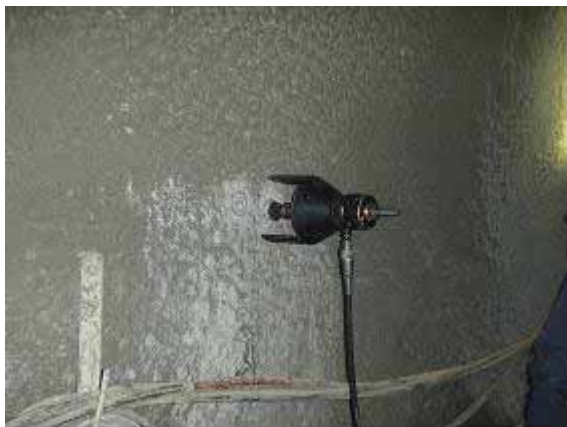
写真-2 付着試験実施状況
