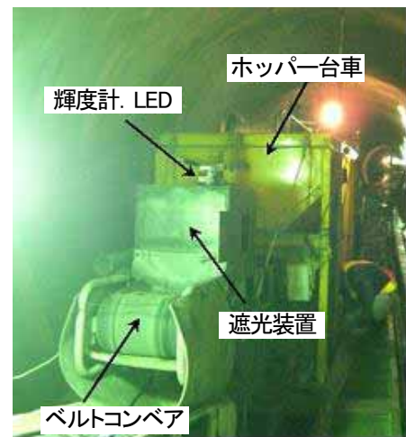
写真-1 輝度計による含水量の測定状況
