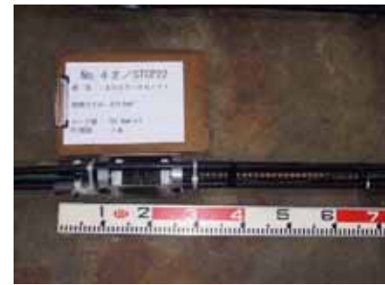
写真-8 鋼製第2耐荷体
