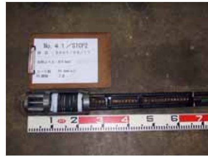
写真-7 鋼製第1耐荷体
