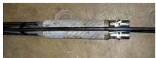
写真-10 コンクリート製第2耐荷体
