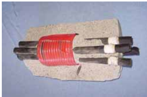
写真-3 モルタル内での切断実験
