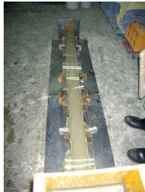
写真-7 箱形充てん試験実施状況
