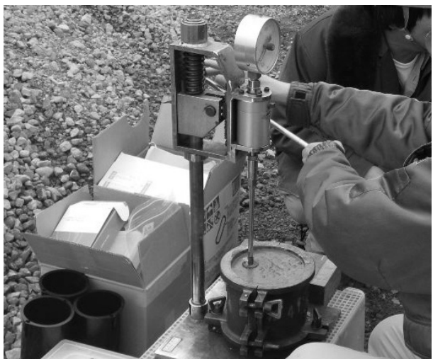
写真-2 現場でのプロクター貫入試験実施状況
