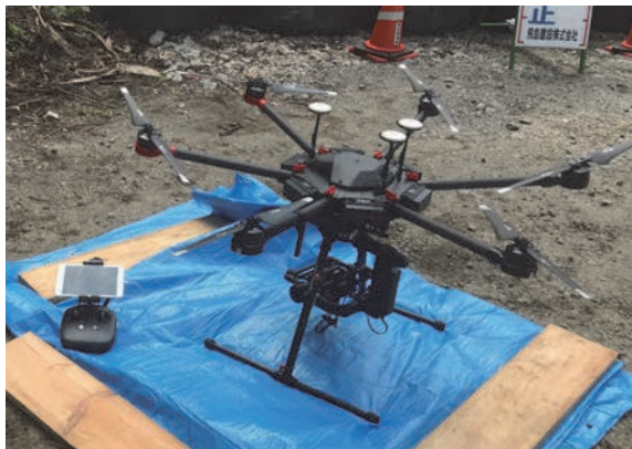
写真—1 レンズ交換式カメラを搭載したUAV
