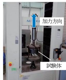
写真-2 付着実験状況
