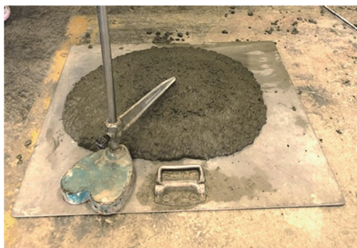
写真-5 Smart Lining System™用コンクリート(練上がり)
