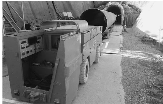
写真一3 ガイドローラー付きタイヤ式搬送車
