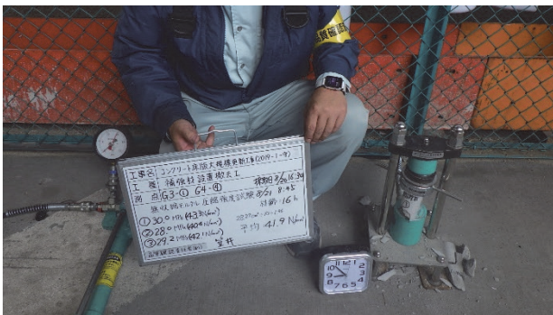
写真-5 現場圧縮強度試験
