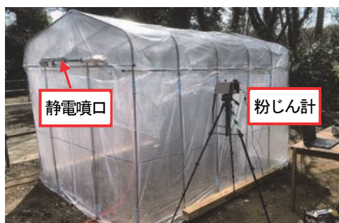
写真-1 帯電ミストの効果検証実験の状況
