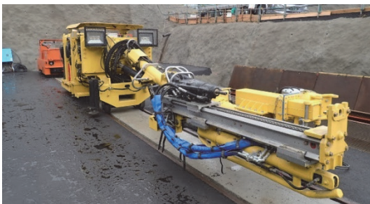
写真-1 ドリルジャンボ (HD190級ドリフター搭載)
