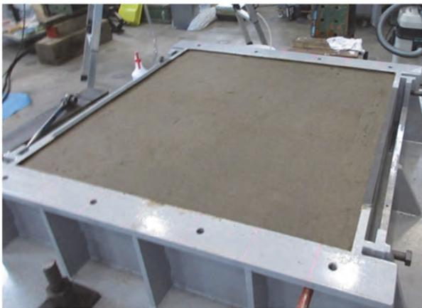
写真-2 締固め後の砂層上面の状況
