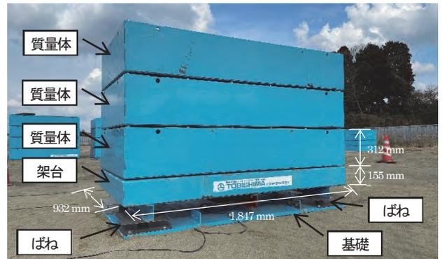
図-1 振動制御装置の設置状況
