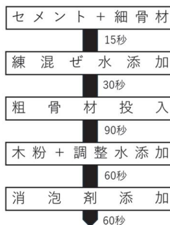
図-1 木粉コンクリートの練り混ぜ方法
