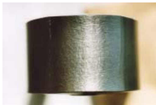
写真-3(b) 曲げ試験結果(表曲げ)
