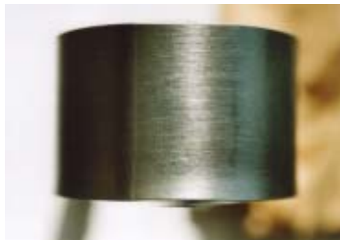
写真-3(a) 曲げ試験結果(裏曲げ)
