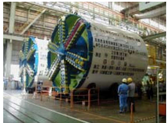
写真-5 工場仮組み立て状況
