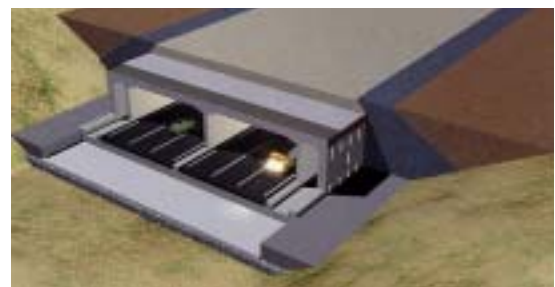
図-2 那覇沈埋トンネルの規格概要図
