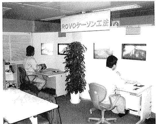
写真-4 遠隔操作による掘削作業状況
