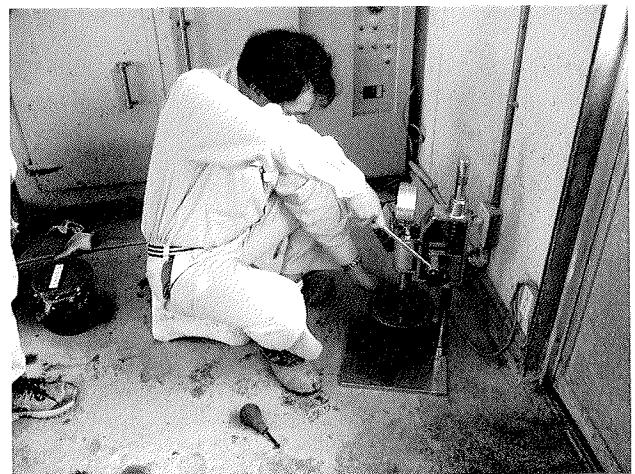
写真-9 混和剤の増量による凝結時間の確認試験
