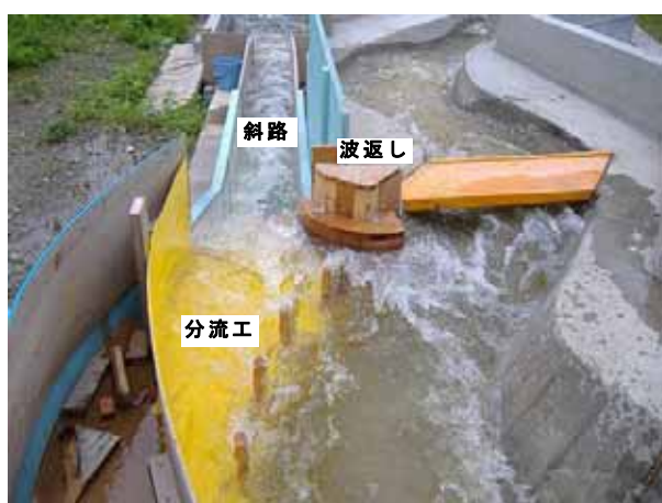
写真-5 水理模型実験(分流工) 流量 47m 3 /s 時
