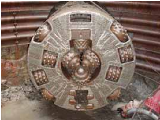
写真-2 掘進機前面(貫通時)
