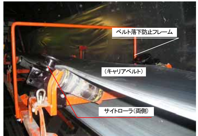
写真-14 蛇行・安全対策品 (ベルト落下防止フレーム・サイトローラ)
