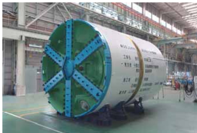
写真-1 φ5.6m泥土圧シールド機
