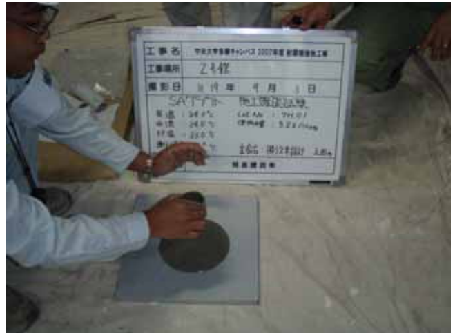
写真6 SAグラウトフロー試験
