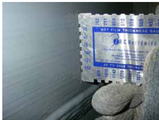
写真1 1 ZRC膜厚確認状況（WET）
