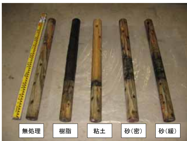
写真-4 7ヵ月後に掘出されたスギの表面状況
