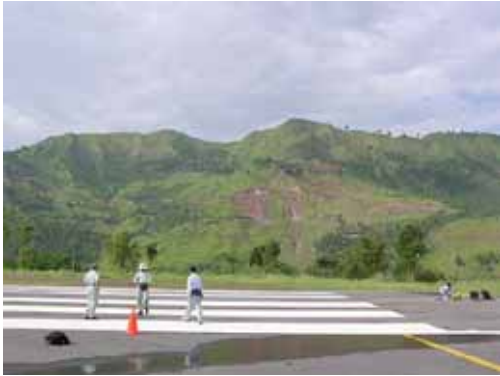
(c) 地盤条件を調べる微動調査
