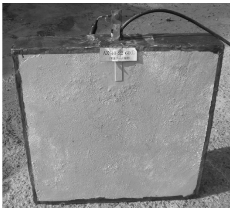
写真-4 2年経過後の溶射被膜の状況
