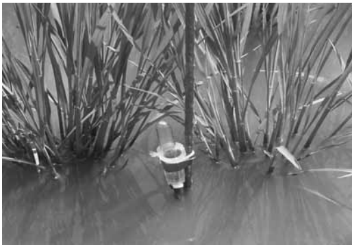
写真-2 採水器設置状況
