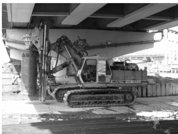
写真-3 低空頭型大口径削孔機 BG7
