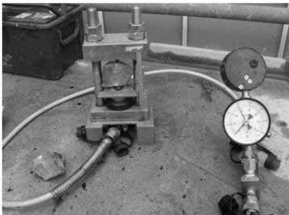
写真-1 点載荷試験実施状況
