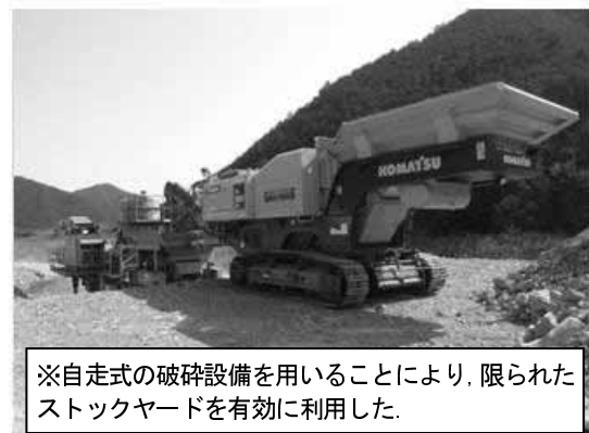
写真-3 自走式破碎設備
