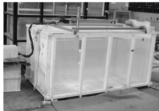
写真-7 実験水槽（幅2m×高さ1m×奥行き1m）
