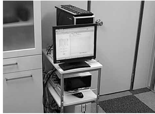
写真-2 WEBモニタリングシステム用の計測PCおよび計測機器（現場事務所内）
