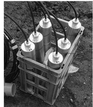
写真-1 FBG傾斜計(設置用5基+予備1基)
