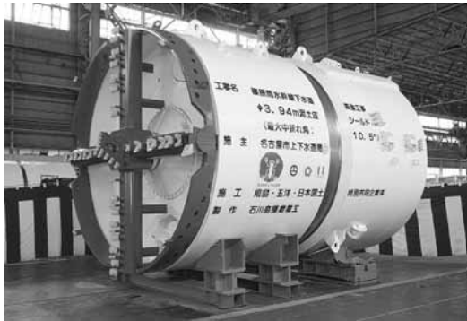
写真-1 シールドマシン（中折れ仕様）
