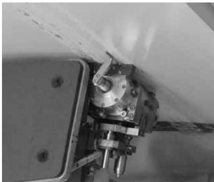
写真-2 クリアランス測定装置
