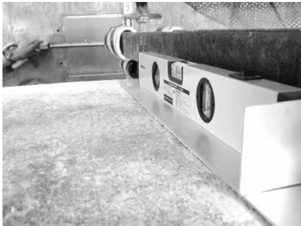
写真-2 函体移動、回転量測定状況
