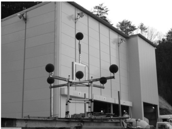
写真-1 騒音モニタリングシステムタイプIII マイクロホンアレー設置状況(大万木トンネル試験)
