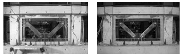
写真-2 架構試験体の最終破壊状況の一例
